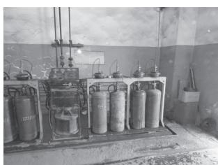
Испытания баллонов водой под давлением 2,5 МПа
