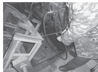
Промывка баллонов горячей водой под давлением для удаления осадка
